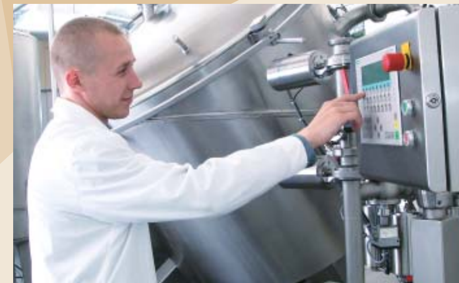
Высокотехнологическое оборудование позволяет контролировать приготовление продукции по программам производства и оперативно регулировать физико-химические показатели (содержание жиров, влаги, сухих веществ, кислотность, стойкость эмульсии)
