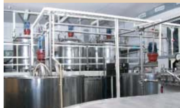
Высокотехнологическое оборудование позволяет контролировать приготовление продукции по программам производства и оперативно регулировать физико-химические показатели (содержание жиров, влаги, сухих веществ, кислотность, стойкость эмульсии)
